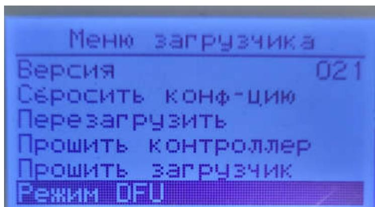
Контроллер перейдет в меню загрузчика, в котором нужно перевести контроллер в режим DFU. Дополнительно подключать питание контроллера не обязательно, т.к. питания от USB кабеля достаточно.
